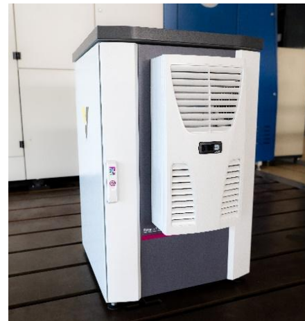
Schaltschrank mit Ultraschalltechnik
