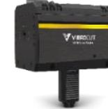
Durch eine Oszillation des Werkzeugs werden Sollbruchstellen in den Span eingebracht und der Spanbruch verbessert. Die **VibroCut oscillate** Werkzeughalter werden am angetriebenen Platz des Revolvers von Drehmaschinen integriert. Die Oszillationsfrequenz wird über die Maschinensteuerung eingestellt. Mithilfe des verstellbaren Oszillationswegs wird der Prozess gezielt auf einen optimalen Spanbruch ausgelegt. Der innovative Aufbau ermöglicht einzigartige Leistungsparameter.
